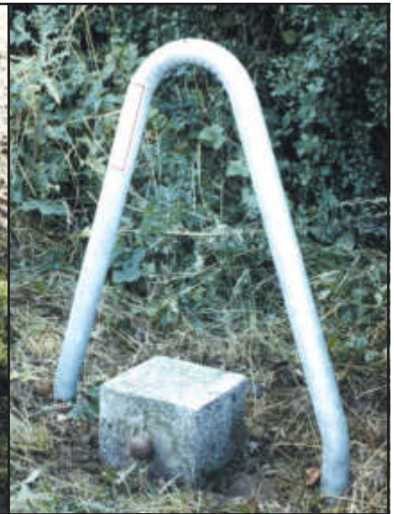
HFP Granitpfeiler 25 cm x 25 cm mit seitlichem Bolzen und Stahlschutzbügel
