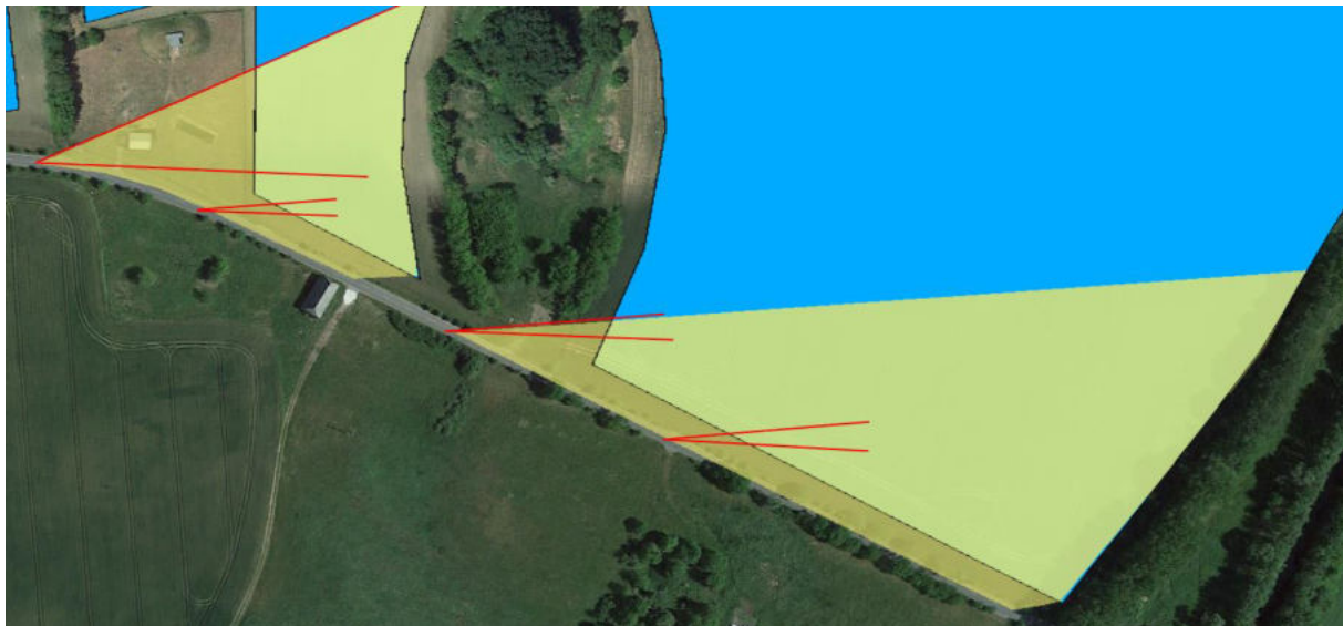
Abbildung 23: potenzielle Blendung im westlichen Teil der Dorfstraße in Fahrtrichtung Westen, betroffener Sichtbereich zwischen roten Markierungen
