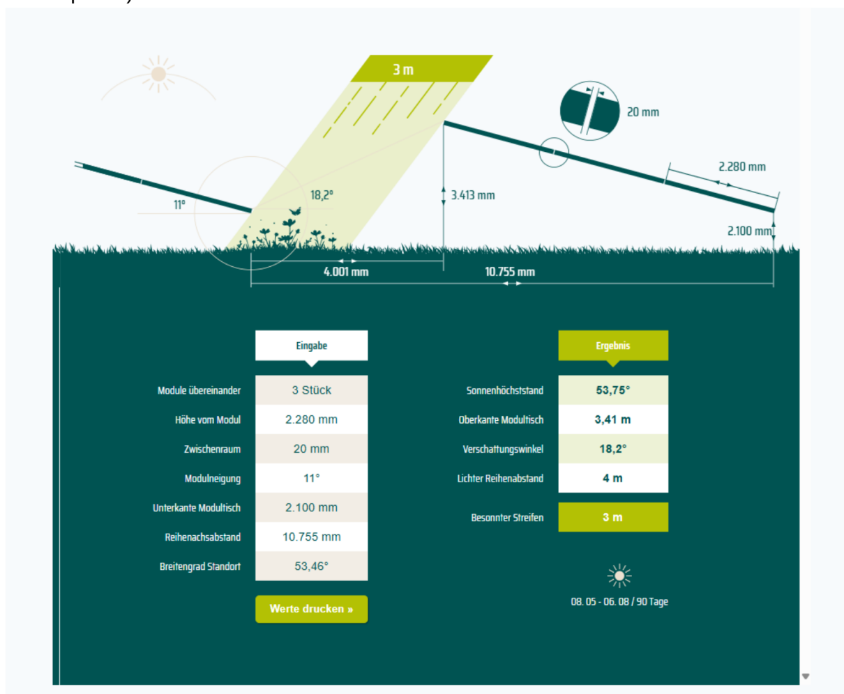
Abb. 10: Berechnung des besonnten Streifens ( https://gute-solarparks.de/besonnter-streifen-in-solarparks/ )
