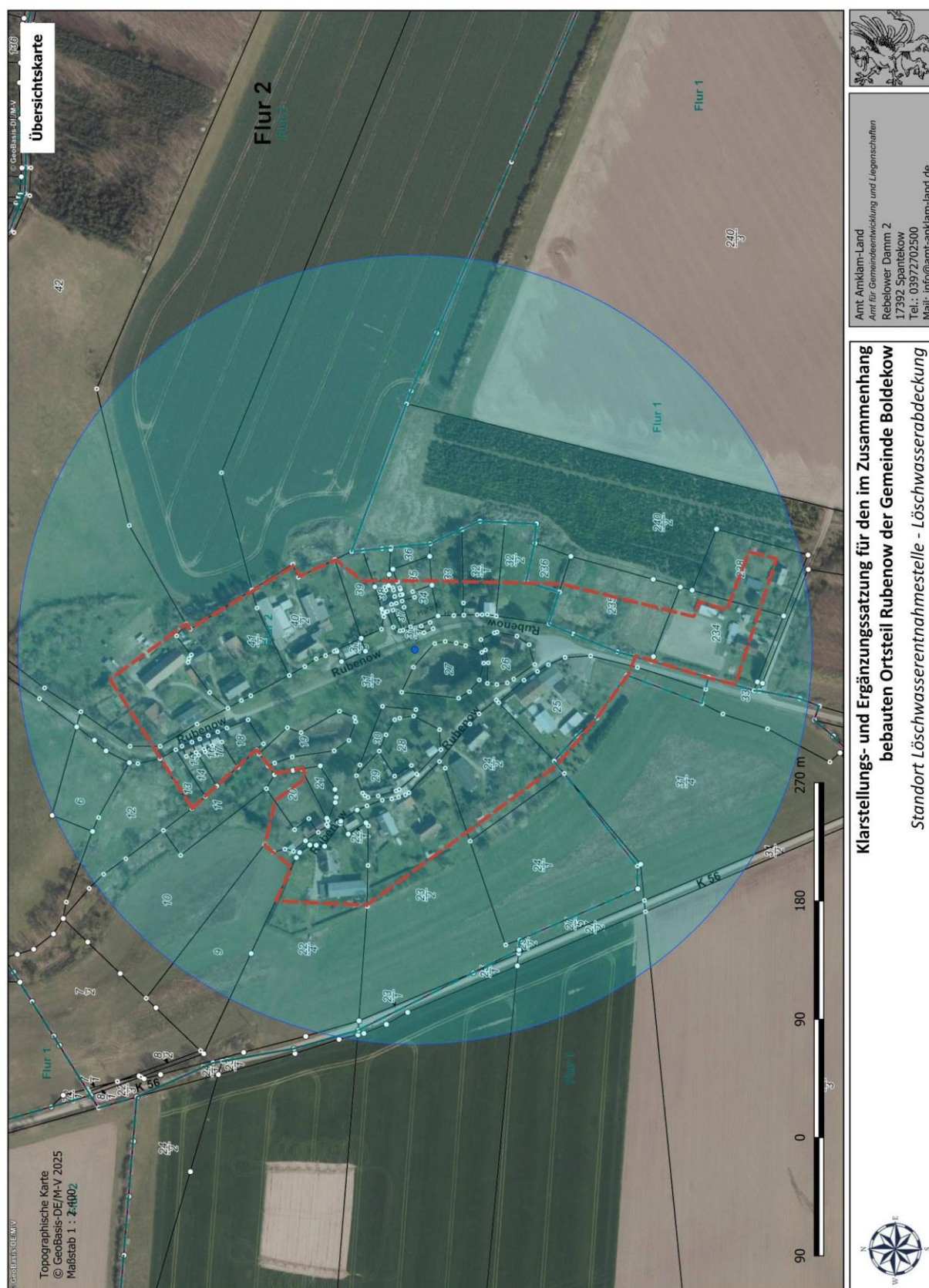
Abb. 05: Geplante Löschwasserentnahmestelle auf dem Flurstück 31/4, Flur 2 der Gemarkung Rubenow mit 300m-Radius (blauer Umring)
