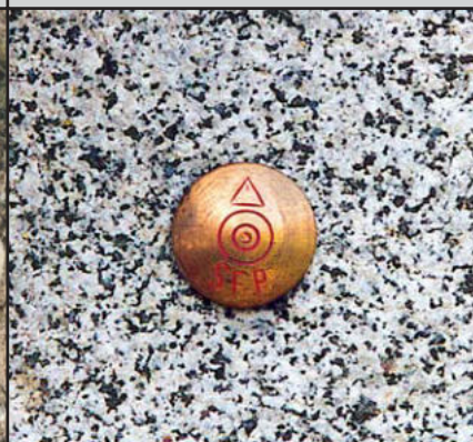
SFP Messingbolzen Ø 3 cm
